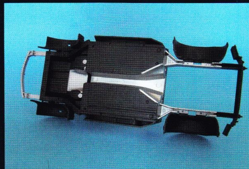
La structure monocoque est entièrement peinte mais partiellement assemblée. La séquence la plus ennuyeuse de sa mise en peinture est le masquage pour une mise en peinture propre du bas de l'habitacle. Notez sur le dessous de la coque le tunnel de transmission peint en XF-16.
