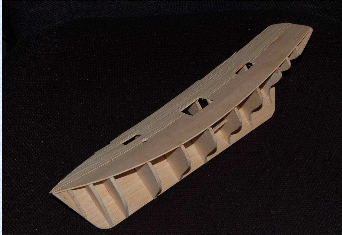
Le lattage du pont a commencé.
