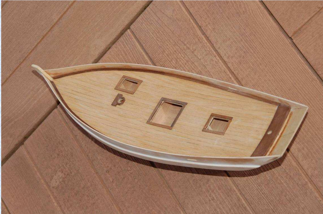
Le pavois et le tableau arrière sont en place.
