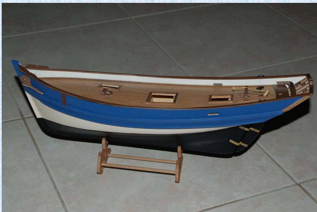
La coque est à présent terminée, le gouvernail a été mis en place.
