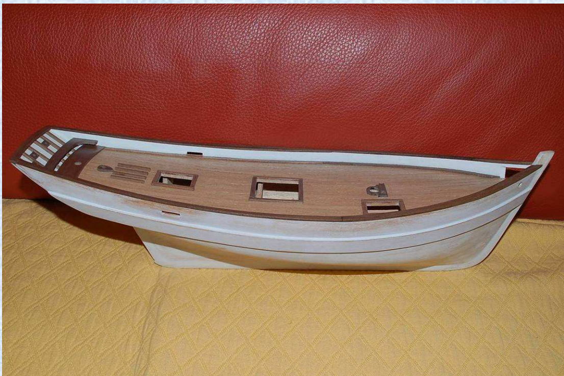
La lisse de pavois a été posée, et une première couche de peinture a été appliquée sur la coque.
